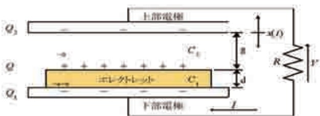
Fig. 5 : エレクトレットを用いた静電誘導発電概念図
