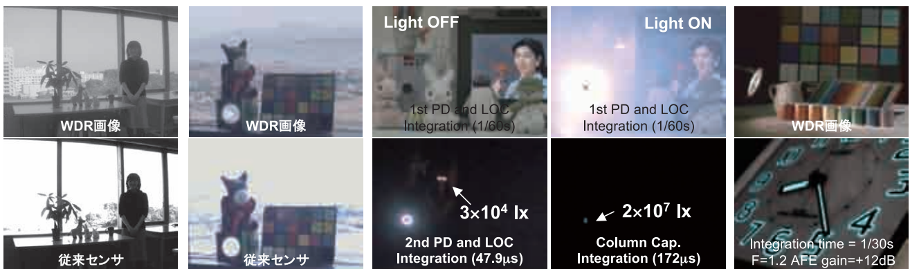
動画撮像性能に優れた高感度WDRイメージセンサ技術
