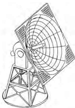
図4. 太陽炉（光直接導入加熱型）のイメージスケッチ （直径10mの放物面鏡を基本とした自動太陽追尾タイプ、焦点に マグネシウム還元レトルトを配置した場合）
