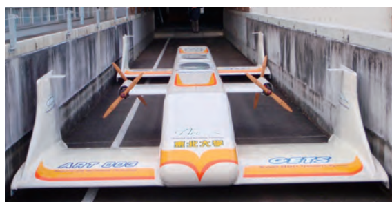
図2. エアロトレインの完成イメージスケッチとNEDOで開発された（難燃性マグネシウム合金製超軽量機体ART003号機）
