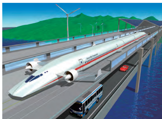
アメリカのインターステーツハイウエー上空間利用の大陸横断タイプ（500km/h、360人乗り、3両編成：ガイドウエー屋根はPV、風車も設置）
